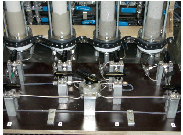
(b) Umschaltventile und Verteiler
