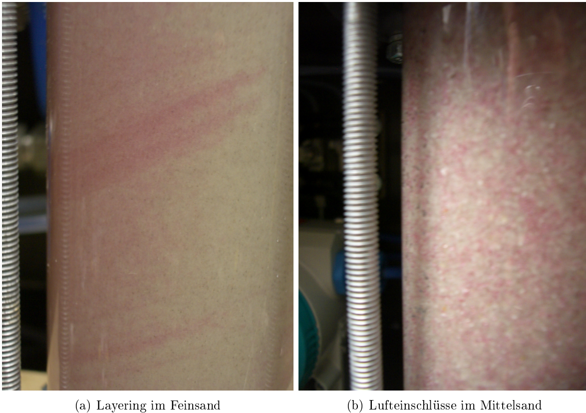
Abbildung 3.4.: Unregelmäßigkeiten in den Säulen
