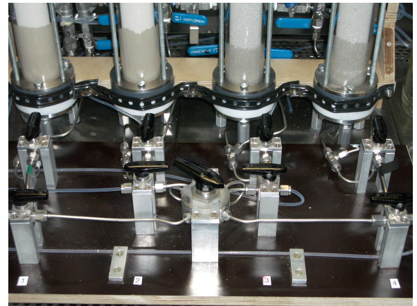
(b) Umschaltventile und Verteiler
