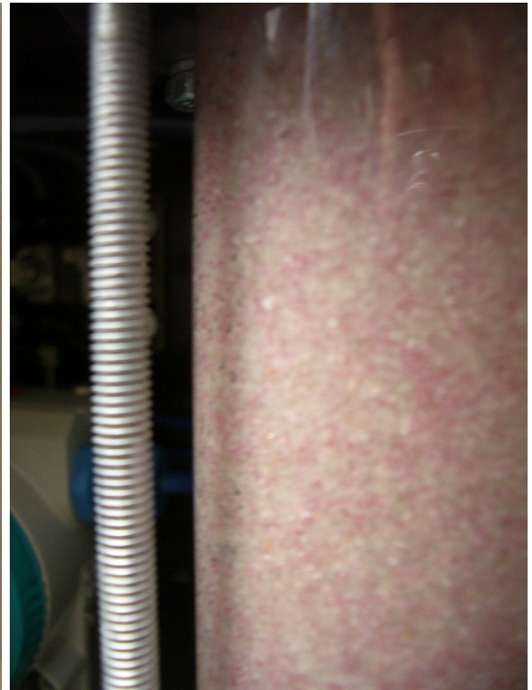
(b) Lufteinschlüsse im Mittelsand
