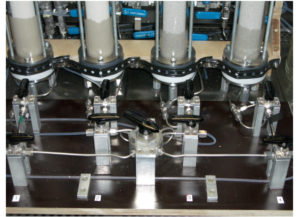
(b) Umschaltventile und Verteiler
