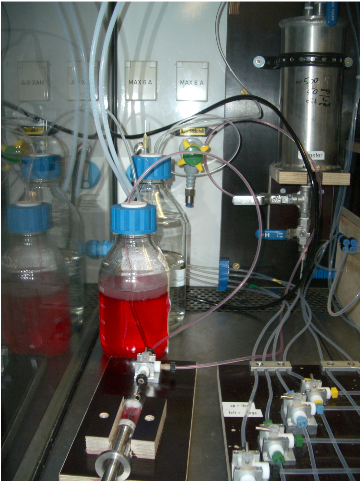
Abbildung 3.6: Befüllen der Vorratsflasche
