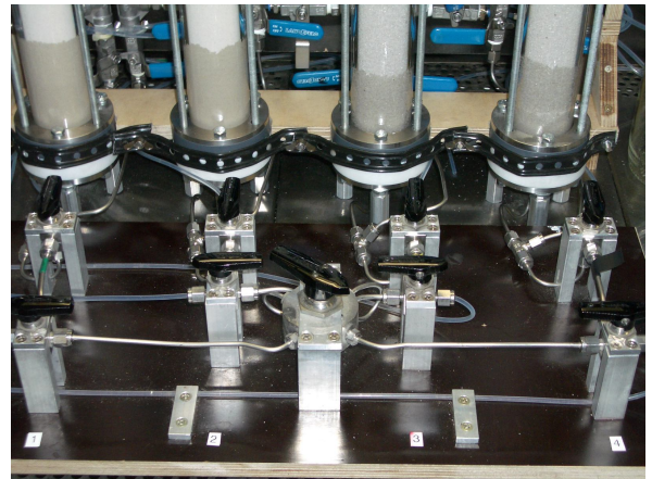
(b) Umschaltventile und Verteiler
