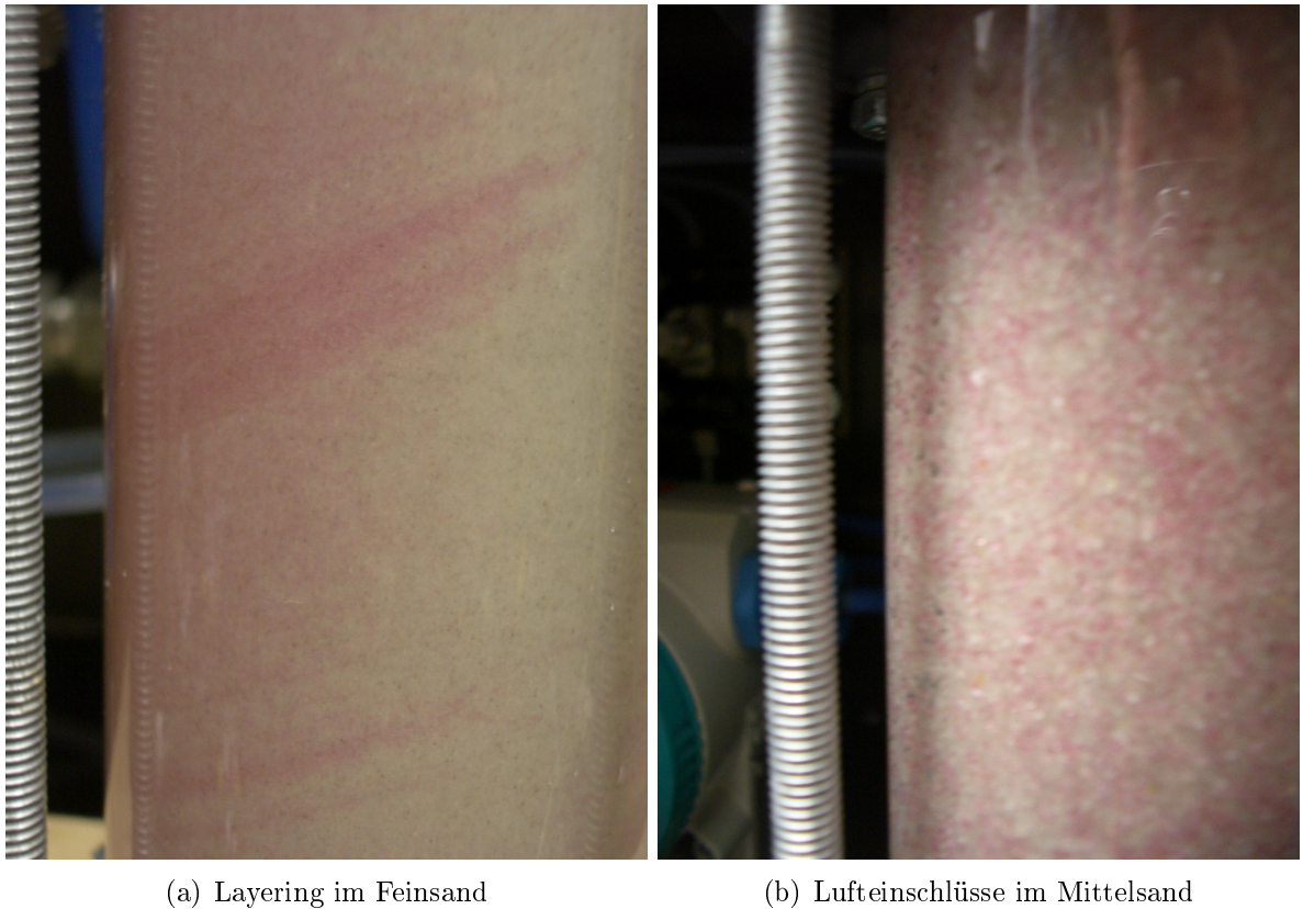
Abbildung 7.1: Unregelmäßigkeiten in den Säulen
