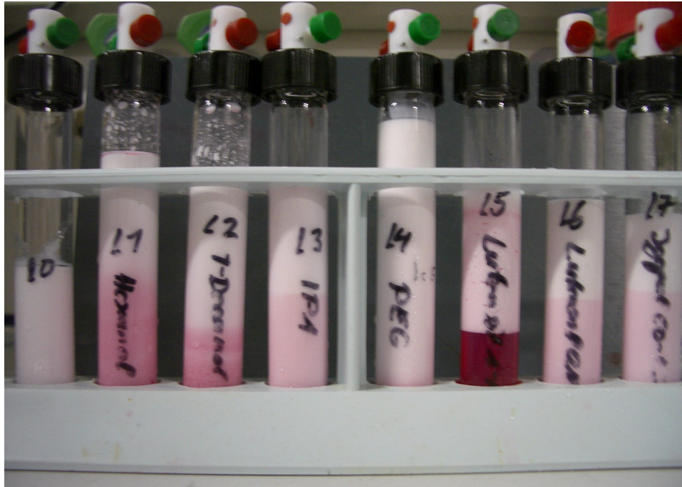
Abbildung 5.4: Reihe 1: Zugabe des Linkers zur bestehenden Emulsion
