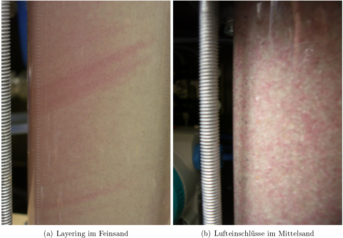
Abbildung 7.1: Unregelmäßigkeiten in den Säulen
