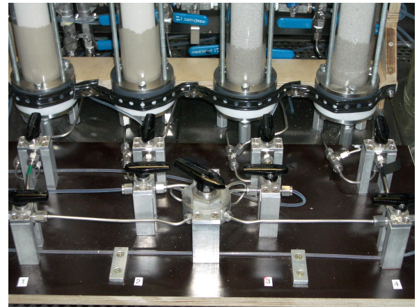
(b) Umschaltventile und Verteiler
