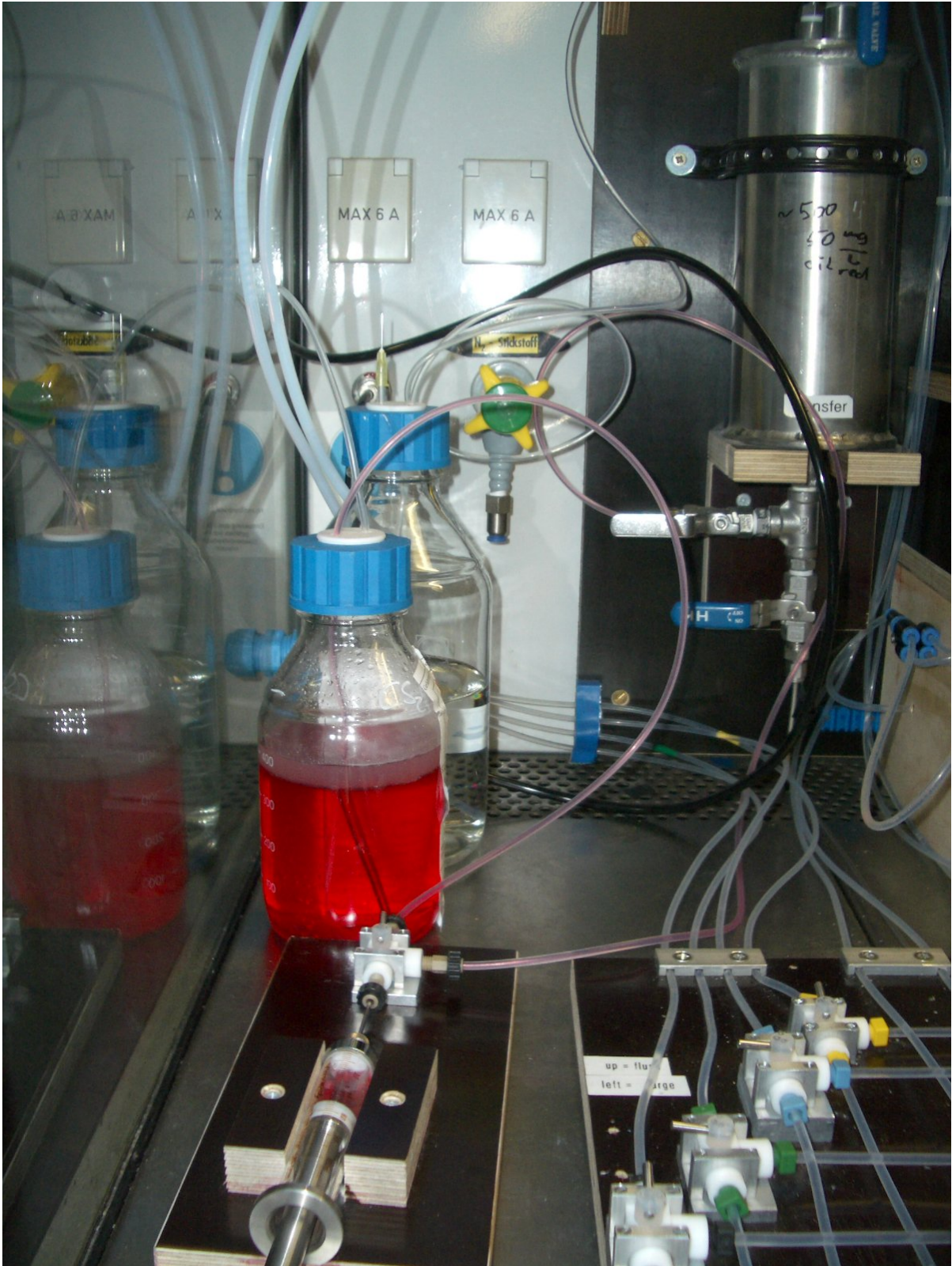
Abbildung 3.6: Befüllen der Vorratsflasche
