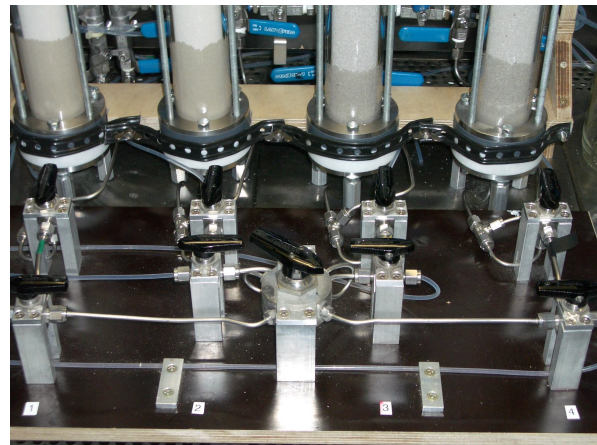
(b) Umschaltventile und Verteiler
