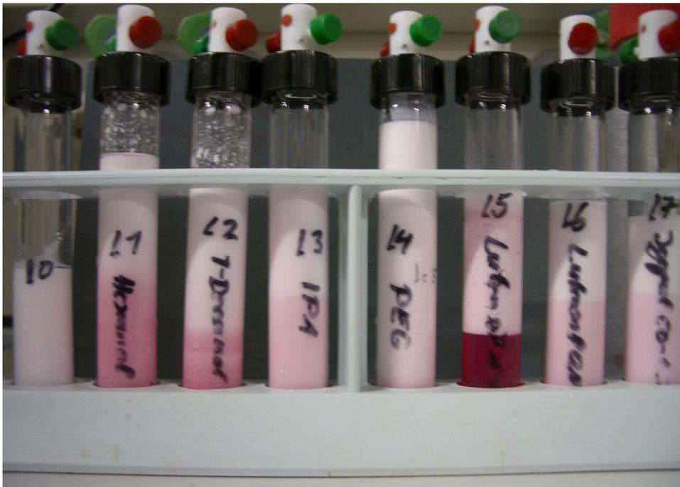
Abbildung 4.4: Kombination einer Stammemulsion mit Linkern und Cotensid
