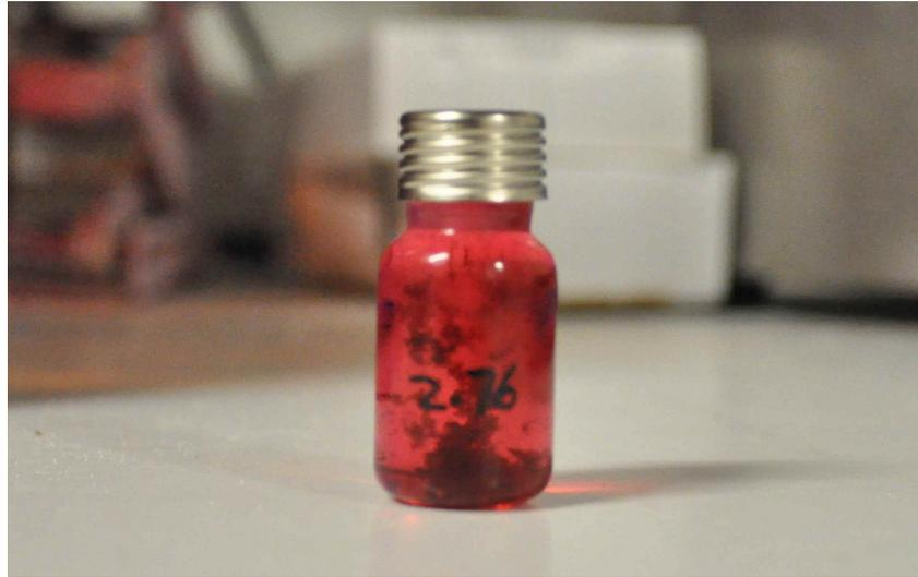
Abbildung 5.2: Polymerisation bei hoher Tracerkonzentration in IPA
