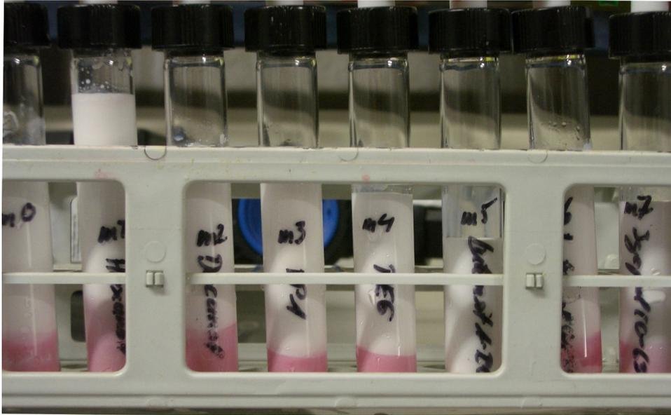
Abbildung 4.6: Erstellen eines Dreikomponentensystems vor Zugabe des DNAPLs
